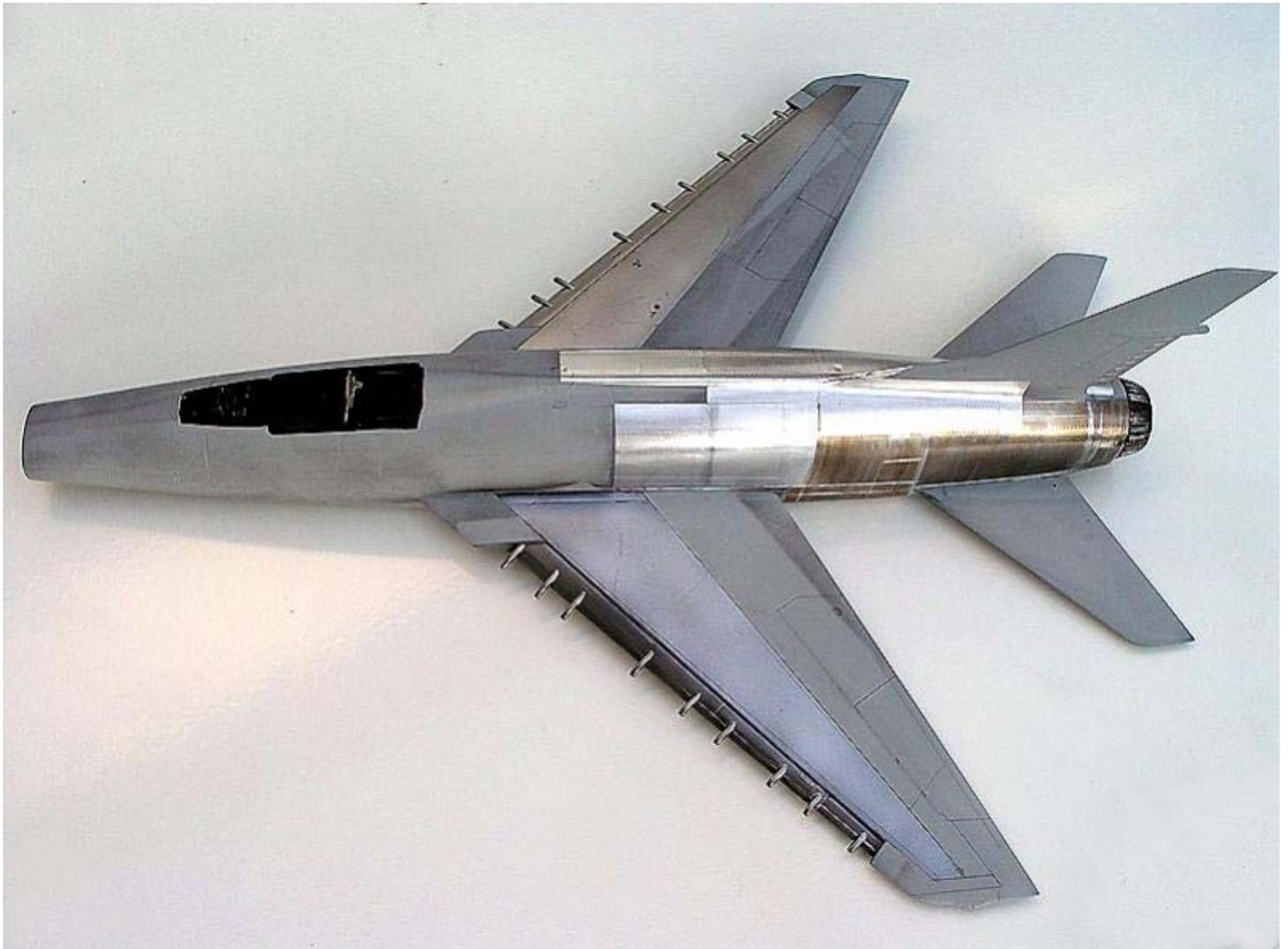
Im Triebwerksbereich kommt die verfärbte Folie zum Einsatz und wird gleich mit einem körnigen Schreibmaschinen-Radierstift bearbeitet um die Walzrichtung der Metallplatten zu unterstreichen.
